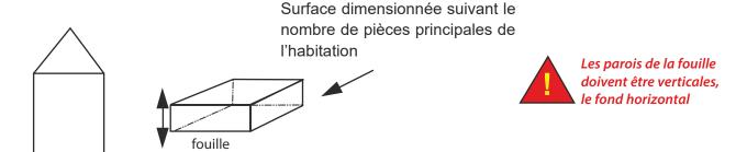
Profondeur : - 1 m sous le niveau de la canalisation d'amenée des eaux.
